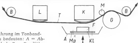
Bandführung im Tonbandgerät. Es bedeuten: A = Abschirmblech, B = Bandführungsbolzen, F = Andruckfilz, G = Gummi-Andruckrolle, K = Kombikopf, Kl = Klebestelle, L = Löschkopf, Mp = Metallplättchen, T = Tonband, X = federnde Verbindung zwischen A und Mp
