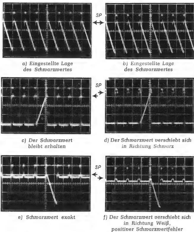
Bild 10. Signalübertragung bei exakter Schwarzhaltung und positivem Schwarzwertfehler mit unterschiedlichem Bildinhalt, oben grau, Mitte weiß, unten schwarz; Oszillogramm von acht Zeilen; SP = Schwarzpegel
