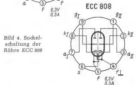
Bild 4. Sockelschaltung der Röhre ECC 808
