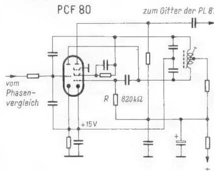
Eine Unterbrechung des Widerstandes R ließ die Gittervorspannung auf -15 V ansteigen, so daß die Röhre gesperrt war
