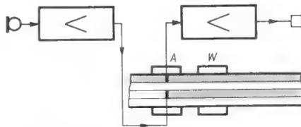
Bild 6. Synchro-Play-Wiedergabe einer Spur bei gleichzeitigem Aufnahmen der Parallelspur. Vorübergehend dient ein System des Aufnahmekopfes zum orientierenden Abhören der oberen Spur
