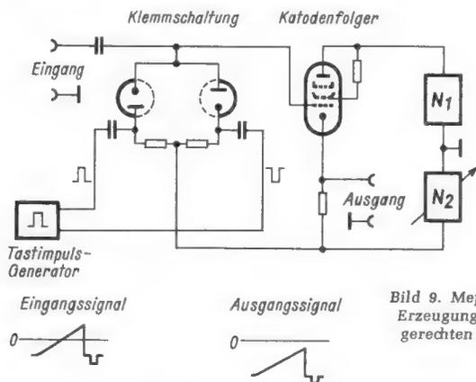
Bild 9. Meßschaltung zur Erzeugung eines normgerechten Videosignals
