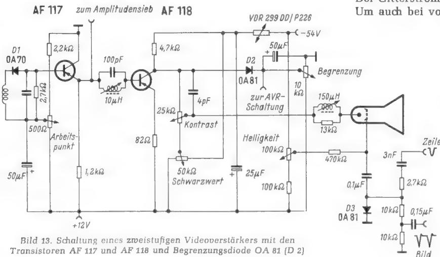
Bild 13. Schaltung eines zweistufigen Videoverstärkers mit den Transistoren AF 117 und AF 118 und Begrenzungsdiode OA 81 (D 2)
