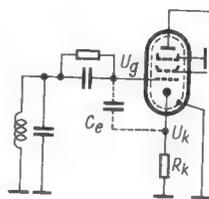
Bild 1. Gegenkopplung durch einen nicht überbrückten Katodenwiderstand
