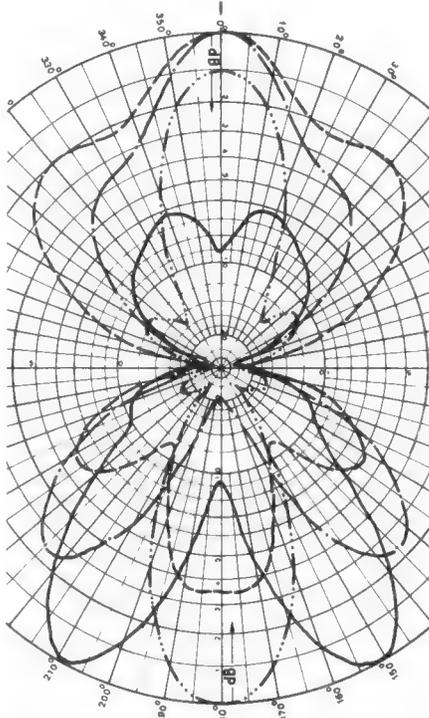
Bild 2. Diagramme des horizontalen Strahlungsfeldes eines Bereich-III-Faltdipols mit Phasereverser für die Frequenzen von 470 bis 790 MHz.
