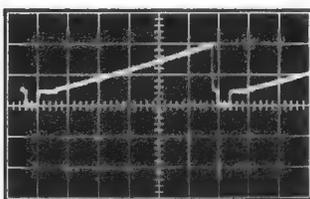
Bild 2. Sägezahnsignal am Eingang des Videoverstärkers mit einer Amplitude von  $1 V_{SS}$  BAS (Teilung in der Höhe =  $0,5 V/\text{Feld}$ )
