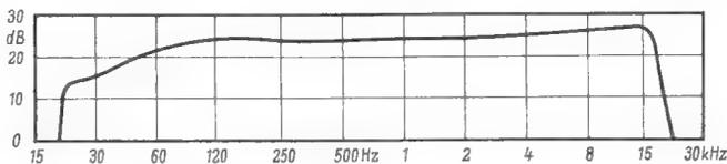
Bild 4. Frequenzgang über alles bei 9,5 cm/sec
