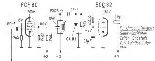
Bild 8. Automatischer Zeilenschalter
