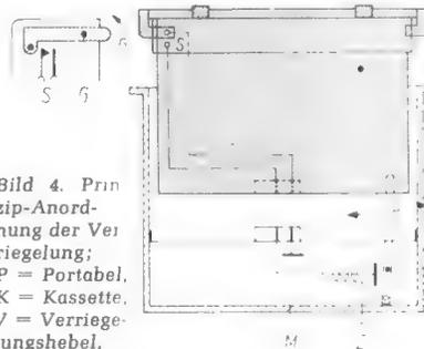
Bild 4. Prinzip-Anordnung der Verriegelung; P = Portabel, K = Kassette, V = Verriegelungshebel, Z = zum Zündschloß führende Leitung, M = Magnetspule; oben links der Schalter S, der erst beim Abklappen des Griffes G geschlossen wird
