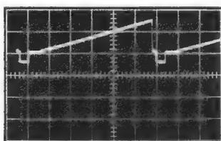
Bild 3. Sägezahnsignal am Emitter des Transistors AF 117 (Teilung in der Höhe =  $0,5 V/\text{Feld}$ )
