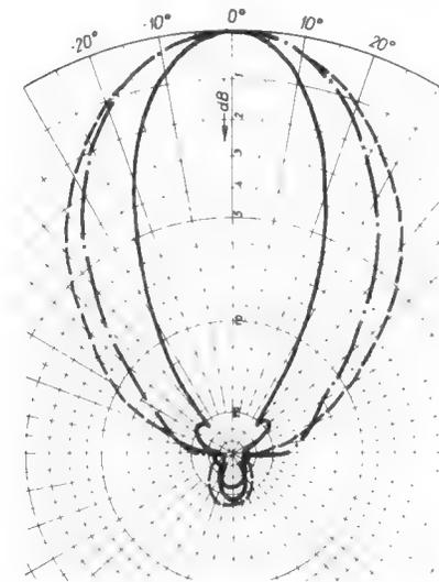
Bild 6. Horizontaldiagramme der FSA 1 U 8 bei 470 MHz (breite Kurve), 600 MHz (mittlere Kurve) und 700 MHz (schlanke Kurve)
