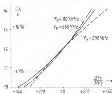
Bild 4. Abhängigkeit der Oszillatorfrequenz von der Betriebsspannung,  $\Delta f_{\text{osz}} = f(U_b)$
