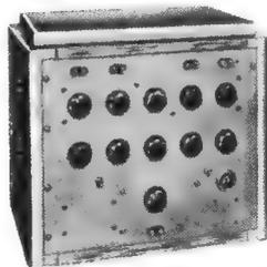
Höchste Gleichstrombelastung bis zu 2 A. Direkte Ablesung von Induktanz und Konduktanz von Eisenspulen bei Tonfrequenzen mit oder ohne Gleichstromvorbelastung. Benutzt werden fünf Dekaden-Widerstände mit einem Höchstwert von 111,11  $\Omega$  in Stufen von 1  $\Omega$ . Frequenzbereich: 20 Hz bis 10 kHz. Fordern Sie vollständigen Katalog und Preisliste an.
