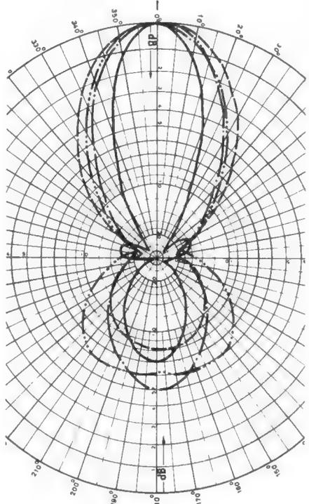
Bild 3. Diagramme des horizontalen Strahlungsfeldes eines Bereich-III-Faltdipols mit eingeformten Sperrkreisen.
