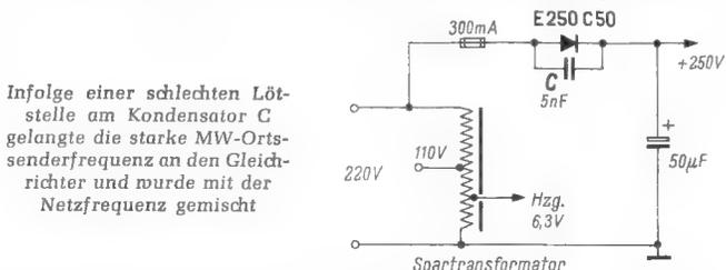
Infolge einer schlechten Lötstelle am Kondensator C gelangte die starke MW-Ortssenderfrequenz an den Gleichrichter und wurde mit der Netzfrequenz gemischt
