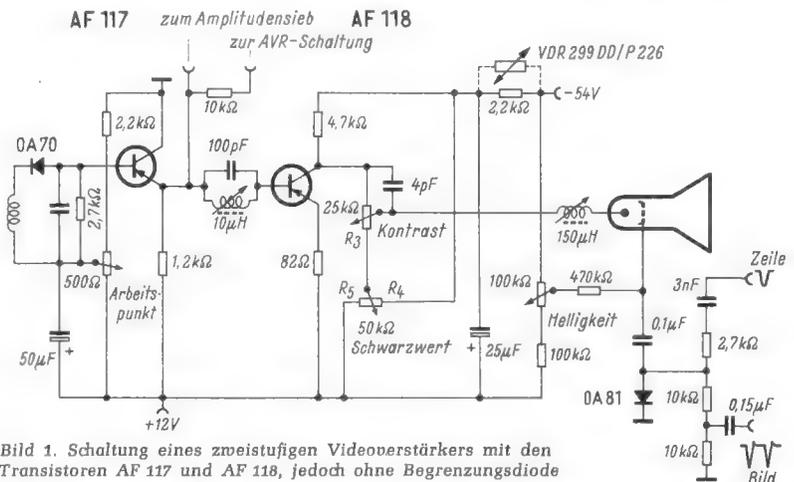
Bild 1. Schaltung eines zweistufigen Videoverstärkers mit den Transistoren AF 117 und AF 118, jedoch ohne Begrenzungsdiode
