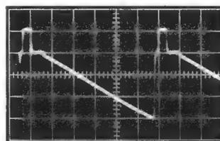
Bild 4. Sägezahnsignal am Ausgang des Videoverstärkers für maximalen Kontrast (Teilung in der Höhe =  $10 V/\text{Feld}$ )
