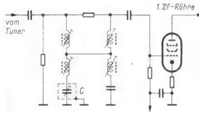
Eine fehlerhafte Lötstelle der Abschirmung des Kondensators C führte bei der geringsten Erschütterung zu starken Störungen in Bild und Ton
