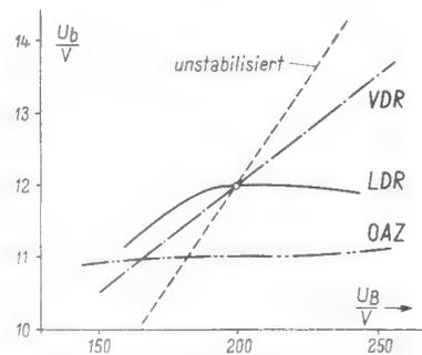
Bild 5. Abhängigkeit der Tuner-Betriebsspannung von der Geräte-Betriebsspannung,  $\Delta U_b = f(U_B)$
