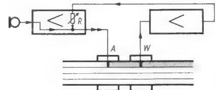
Bild 8. Hall bzw. Echo – die mit Aufnahmekopf A erfolgende Aufnahme wird vom Wiedergabekopf W abgetastet und über den Verstärker wieder dem Aufnahmekopf A zugeführt, wobei mit Einsteller R die Stärke des Effektes eingeregelt wird. Je nach Bandgeschwindigkeit entsteht dabei Hall- oder Echowirkung
