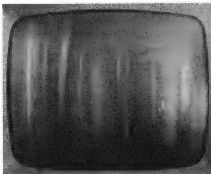
Bild 2. Unretuschierte Aufnahme der Fremdlichtreflexionen an einer V-Röhre
