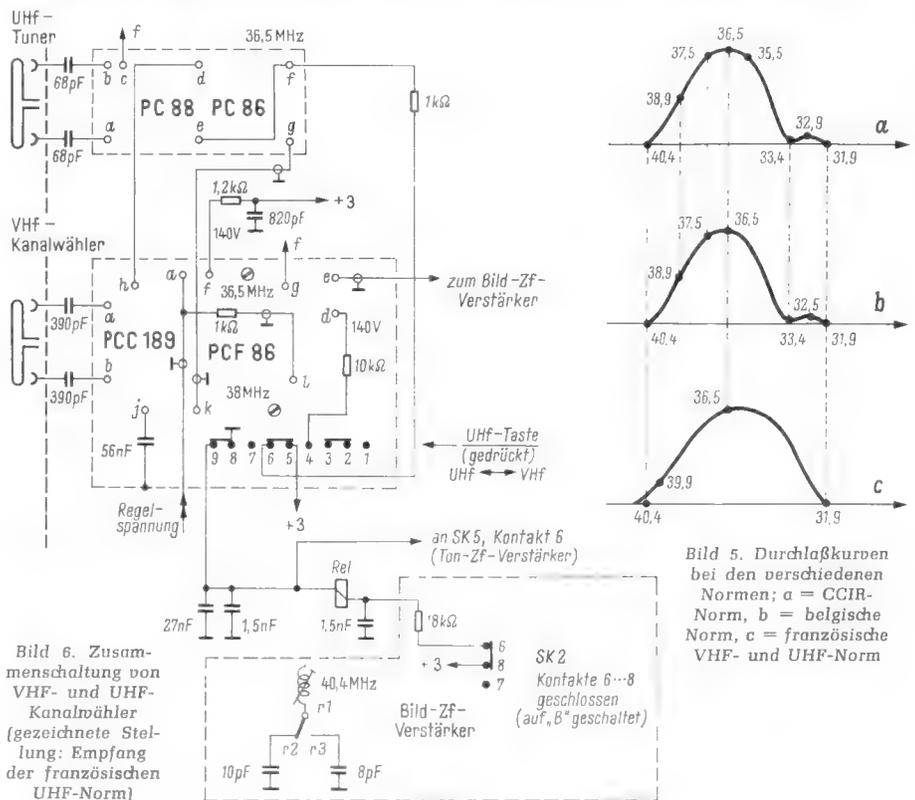
Bild 6. Zusammenschaltung von VHF- und UHF-Kanalwähler (gezeichnete Stellung: Empfang der französischen UHF-Norm)
