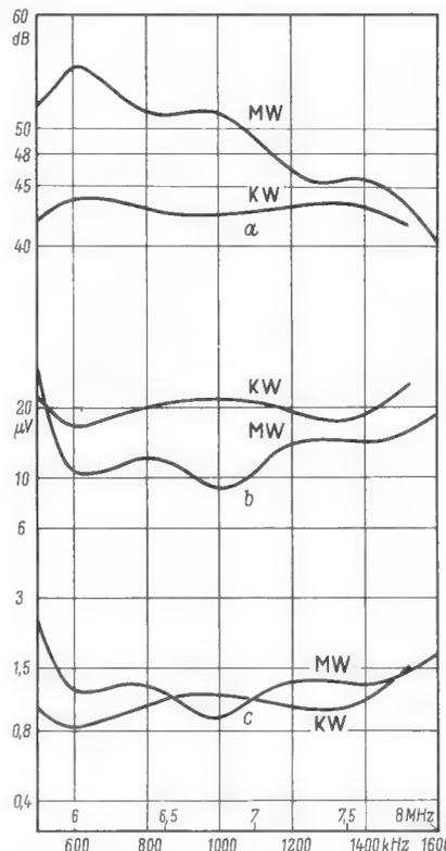
Bild 2. Verlauf der Spiegelsicherheit (a), der Eingangsempfindlichkeit für 500 mW (b) und des Signal/Rausch-Abstandes nach Ensi (c), gemessen über die Autohalterung
