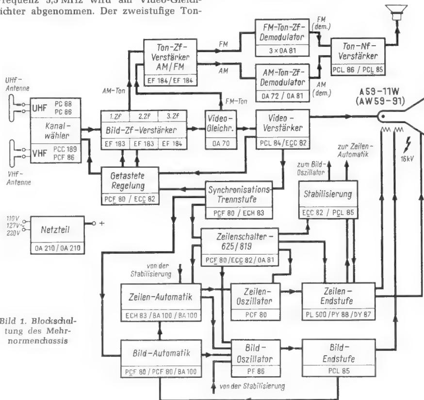
Bild 1. Blockschaltung des Mehrnormen-Chassis
