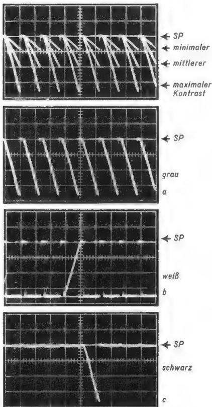
Bild 18. Schwarzwerthaltung bei Kontrastverstellung; Sägezahn-signal über acht Zeilen
