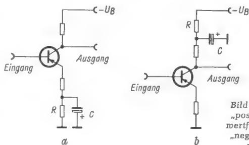
Bild 11. Schaltung mit „positivem“ Schwarzwertfehler (a) und mit „negativem“ Schwarzwertfehler (b)
