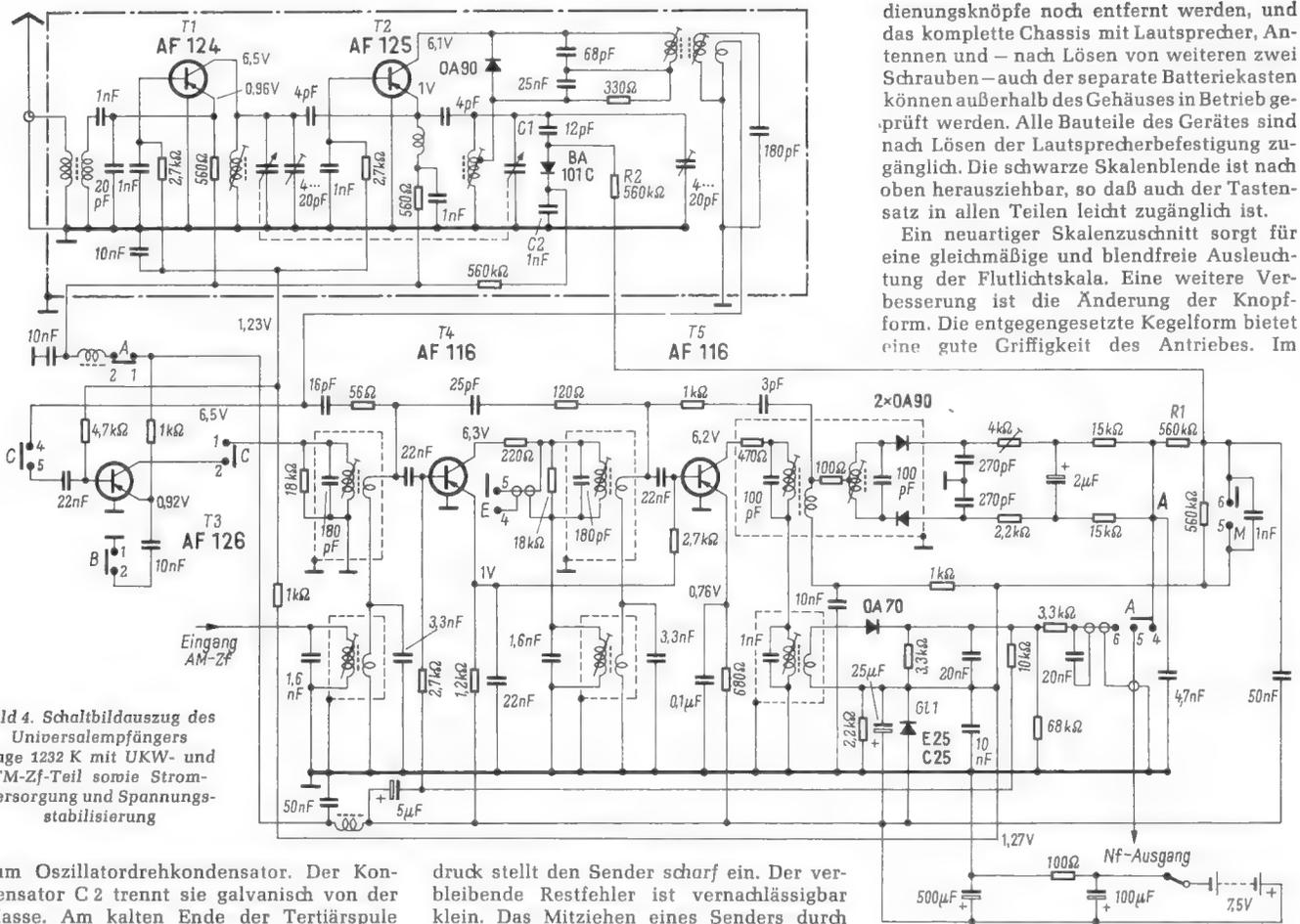
Bild 4. Schaltbildauszug des Universalempfängers Page 1232 K mit UKW- und FM-Zf-Teil sowie Stromversorgung und Spannungsstabilisierung
