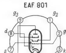
Bild 3. Sockelschaltung der Röhre EAF 801
