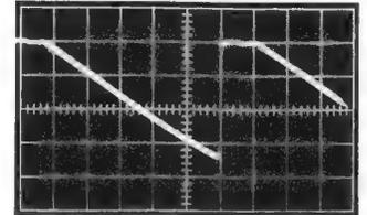
Bild 15. Sägezahnsignal am Ausgang des Videoverstärkers mit Begrenzungsdiode (Teilung in der Höhe = 10 V/Feld)
