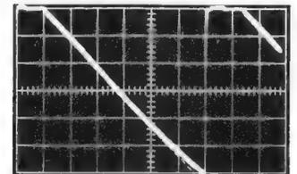
Bild 16. Aussteuerungscharakteristik des Videoverstärkers mit Begrenzungsdiode, gestrichelt der Verlauf bester Linearität
