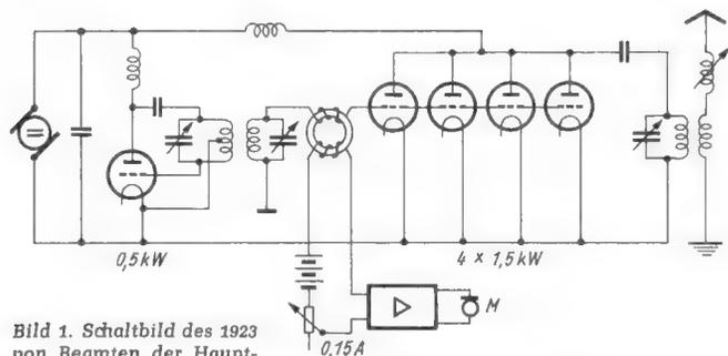
Bild 1. Schaltbild des 1923 von Beamten der Hauptfunkstelle Königswusterhausen erbauten „Konzertsenders“ für Langwellenbetrieb mit Drosselmodulation
