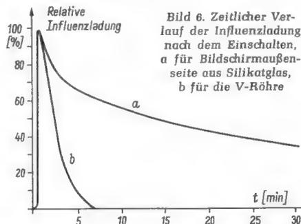
Bild 6. Zeitlicher Verlauf der Influenzladung nach dem Einschalten, a für Bildschirm- und b für die V-Röhre
