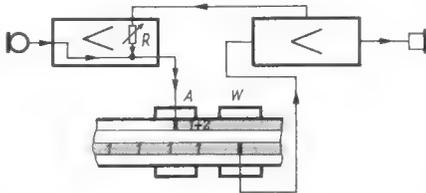
Bild 7. Multi-Play – das Programm (1) einer Spur wird wiedergegeben, gleichzeitig auf die Parallelspur überspielt und eine weitere Aufnahme (2) zugelegt. Die obere Spur enthält somit Programm 1 und 2. Der Einsteller R dient zum Dosieren des Lautstärkeverhältnisses
