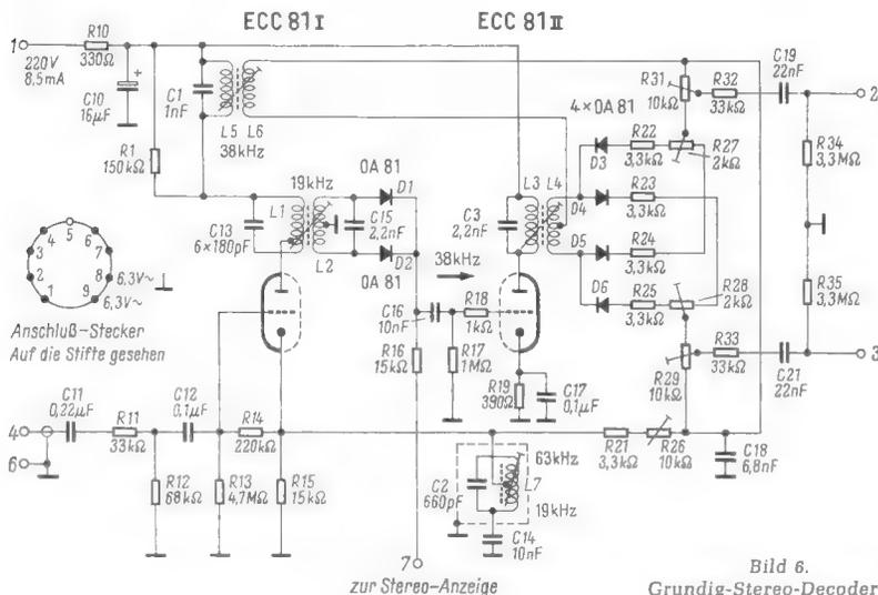
Bild 6. Grundig-Stereo-Decoder IV
