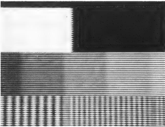
Bild 7. Unretuschierte Aufnahme eines Testbildausschnittes der M-Röhre
