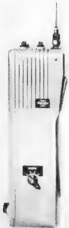
Bild 1. Neues Handfunksprechgerät mit vier Kanälen
